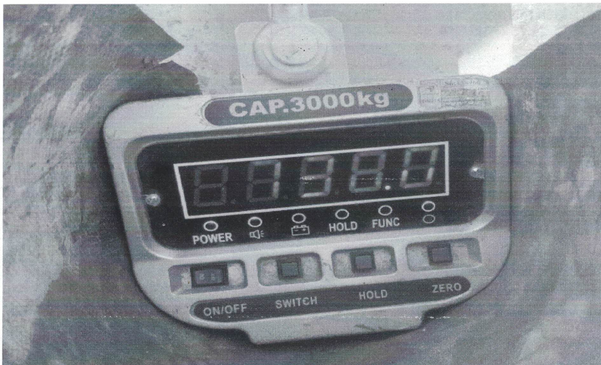
* Ảnh 3: Thử uốn nứt ở mức \geq 200\% tải trọng thiết kế.
