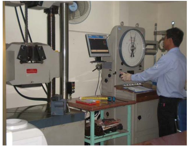
THỬ KÉO THÉP TRONG PHÒNG THÍ NGHIỆM.
