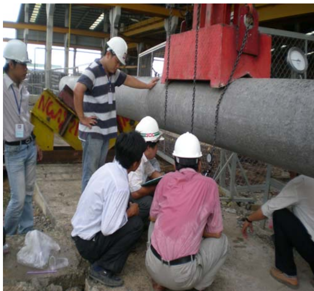
THỬ NGHIỆM KIỂM TRA MOMEN UỐN GÂY NỨT CỌC ỒNG
