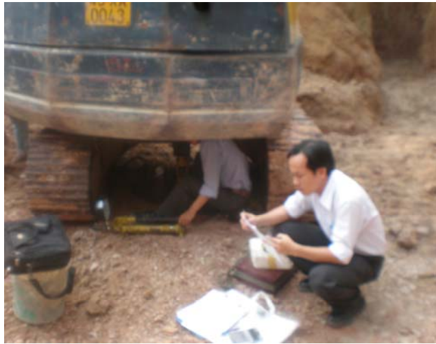
THỬ NGHIỆM XÁC ĐỊNH SỨC CHỊU TẢI NỀN ĐẤT TẠI HIỆN TRƯỜNG.
