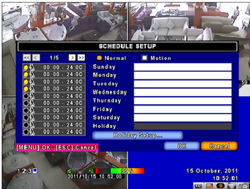
Hình 7: Cài đặt lịch trình ghi hình ở chế độ bình thường.
