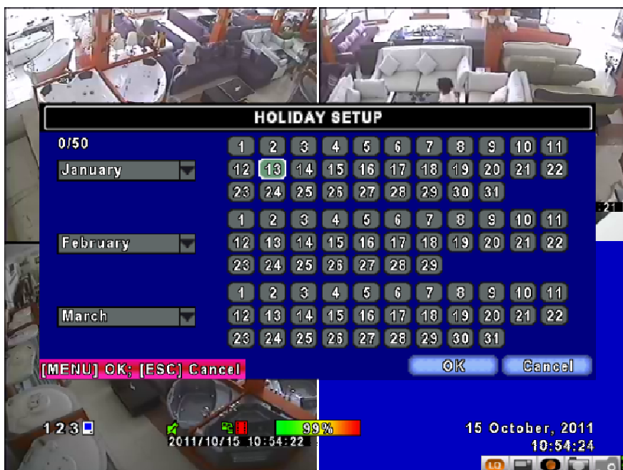
Hình 8: Cài đặt lịch trình ghi hình theo ngày nghỉ.
