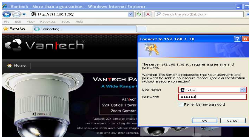
Hình 1: Truy cập vào đầu ghi qua trình duyệt web.
