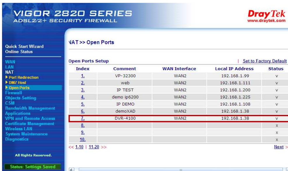
Hình 13: Mở port thành công.
