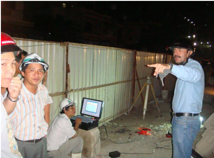
THỬ NGHIỆM CỌC KHOAN NHỒI BẰNG PHƯƠNG PHÁP PDA TẠI CÔNG TRÌNH CẦU THỦ THIÊM
