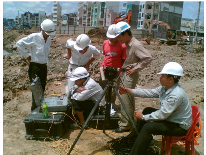
THỬ NGHIỆM CỌC KHOAN NHỒI BẰNG PHƯƠNG PHÁP PDA TẠI CÔNG TRÌNH CẦU THỦ THIÊM
