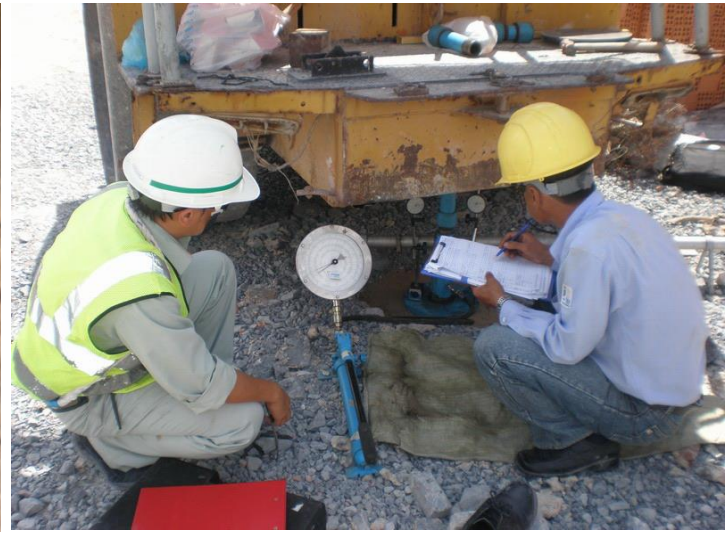
THỬ NGHIỆM XÁC ĐỊNH SỨC CHỊU TẢI NỀN ĐẤT TẠI HIỆN TRƯỜNG.
