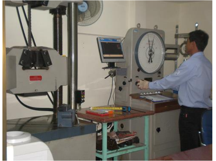
THỬ KÉO THÉP TRONG PHÒNG THÍ NGHIỆM.
