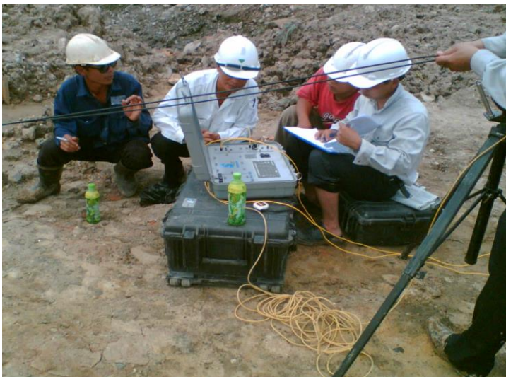
THỬ NGHIỆM CỌC KHOAN NHỒI BẰNG PHƯƠNG PHÁP PDA TẠI CÔNG TRÌNH CẦU THỦ THIÊM
